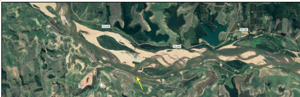
Figura 52 – Imagem Digital Globe 2018, mostrando o ponto “28d” na margem direita destituído de vegetação marginal com o processo de erosão de 2,87 km .
